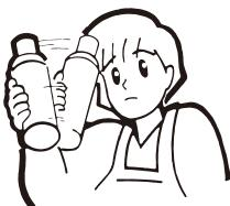
1.容器(ボンベ)を振ってサラサラと音がする時は、まだガスが残っています。そのまま温度の高い所に放置したり、ゴミに混入すると危険です。お湯を沸かすなどで使い切ってください。
